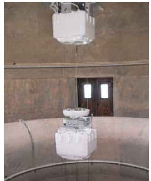
Völkerschlachtdenkmal, Leipzig DE - Tandemlösung (2 Lifte übereinander / Absenkhöhe 60m, Traglast 100kg)
